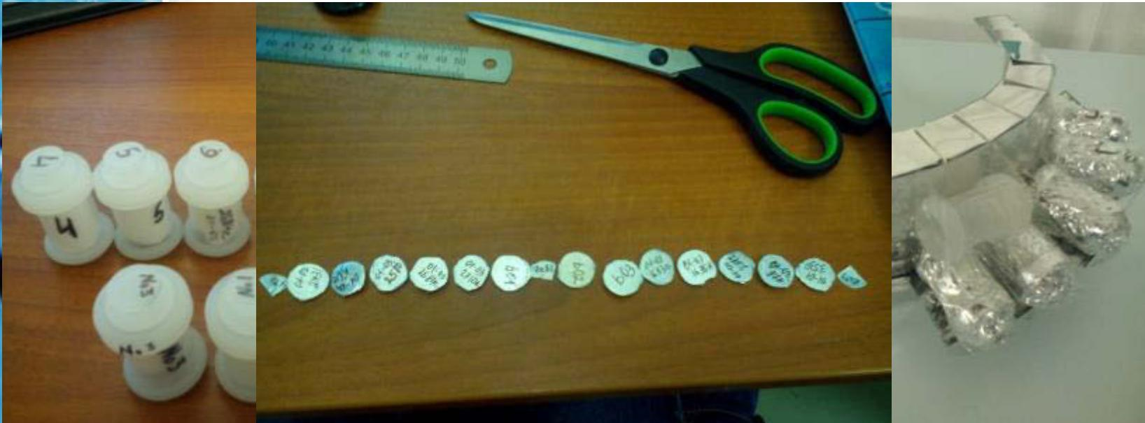
Fig.5. Probele analizate și standartele ambalate în containere de plastic pentru iradierea la insulație IREN
