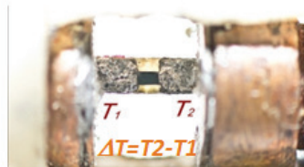
Fig. 2,b Strat Bi 2 Te 3 metoda de 2 contacte
