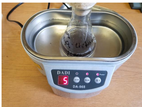
Fig. 2.3. Prepararea soluției stoc de nanoparticule procesor cu ultrasunete de 50 W
